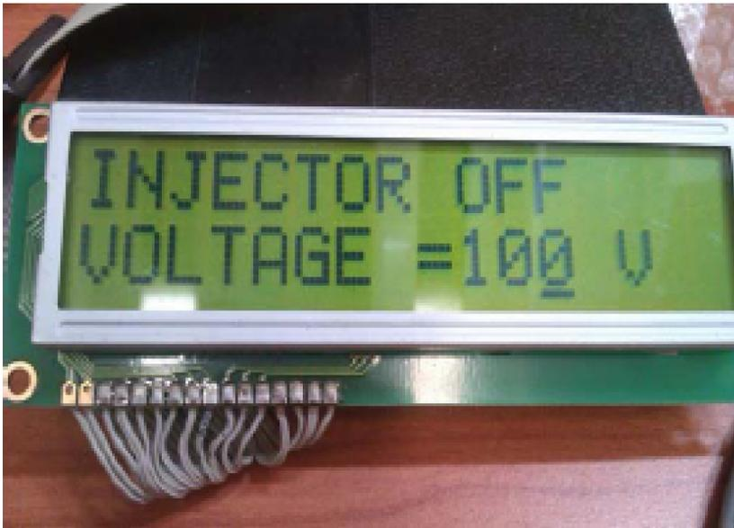
Курсор будет помещен в окно выбора инжектора в выключенном состоянии (OFF), для перехода в меню выбора напряжения (по умолчанию 100 v) необходимо нажать на ручку регулятора настройки на панели прибора.
